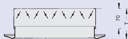
... - AG Przepustnica regulacyjna z przeciwbieżnymi kierownicami ustawianymi od przodu.
