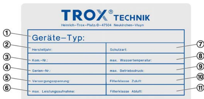
Rys. 33: Tabliczka znamionowa jest przymocowana do obudowy.
