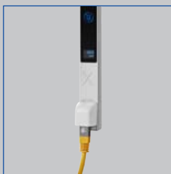
Gniazdo serwisowe do podłączania narzędzia konfiguracyjnego
